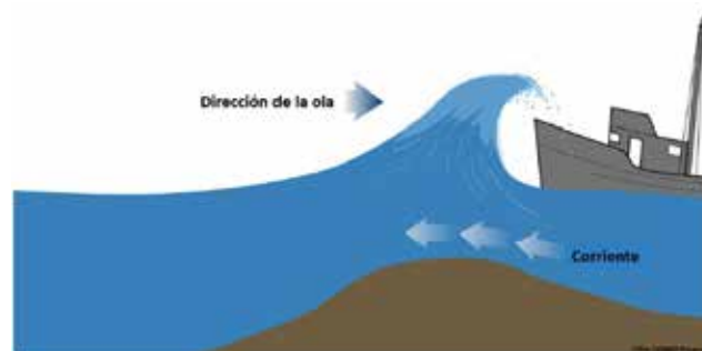
Figura 3. Esquema simplificado del efecto Doppler que experimenta el oleaje al transitar por una zona de bajos, o en aguas someras, cuando una corriente de cierta intensidad tiene sentido contrario, reforzando la altura y la pendiente de las olas en el proceso de rotura. Fuente: módulos COMET ( http://www.comet.ucar.edu ).
