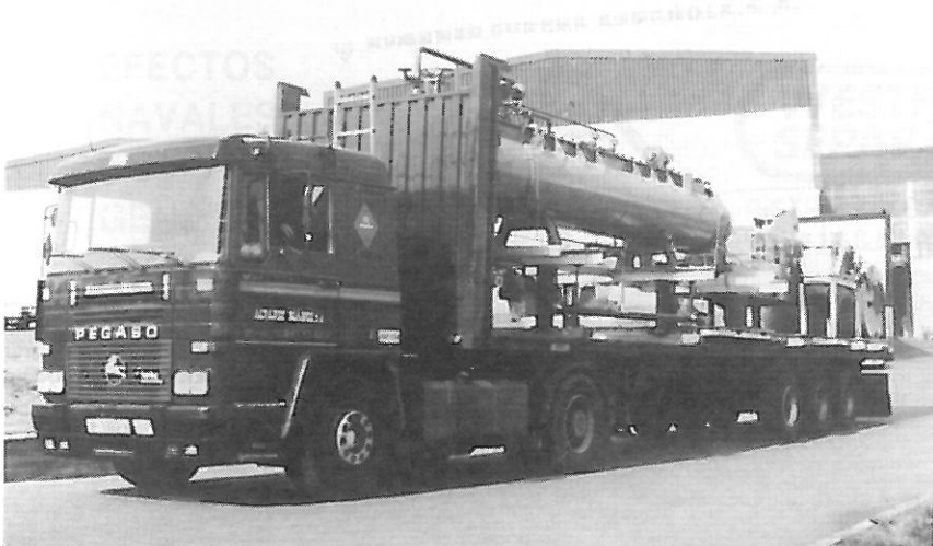
Planta de harina de pescado transportada en módulos desde la factoría de Kvaerner Eureka Española, S. A.
