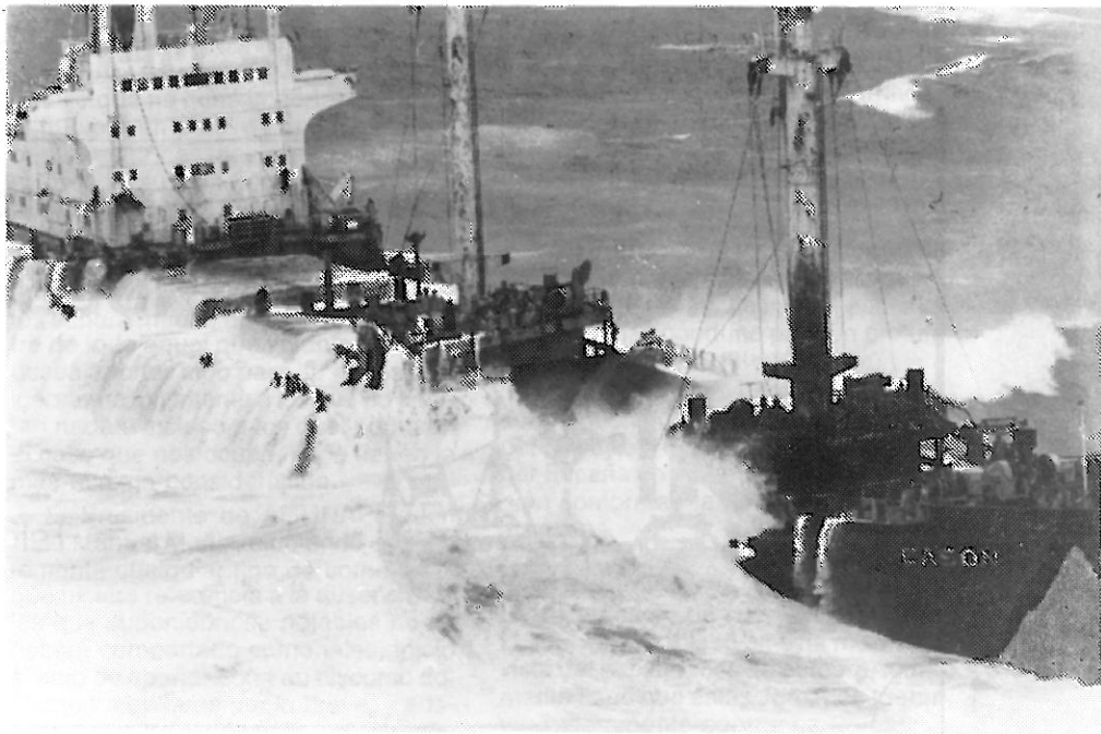
El mar barriendo la carga del «Cason» embarrancado con una importante ruptura en el costado de estribor.
